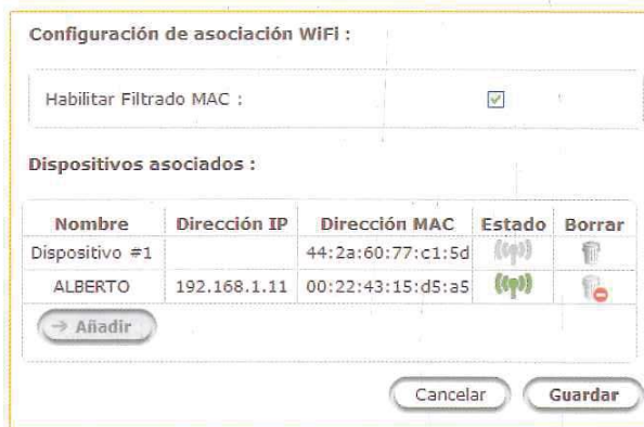
Fig. 29. Filtrado MAC de dispositivos que pueden acceder al router.
