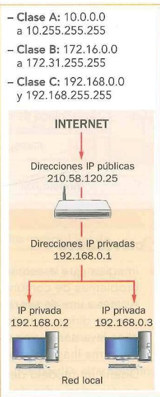
Fig. 5. Esquema de direcciones IPv4 públicas y privadas en una red de área local conectada a Internet.
