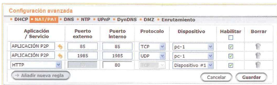
Fig. 30. Router con los puertos 85 (TCP) y 1985 (UDP) abiertos.
